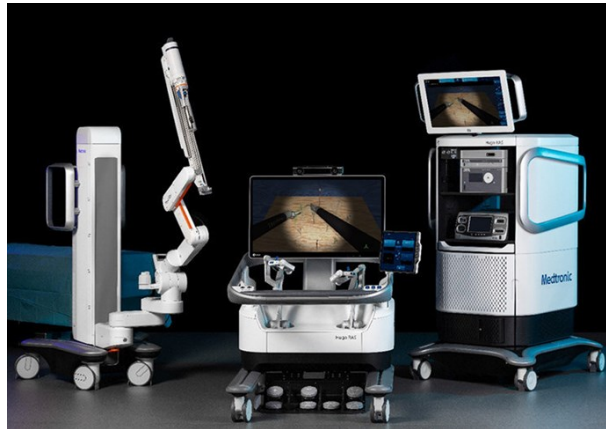
Overview of the Medtronic Hugo RAS (medtronic.com)
